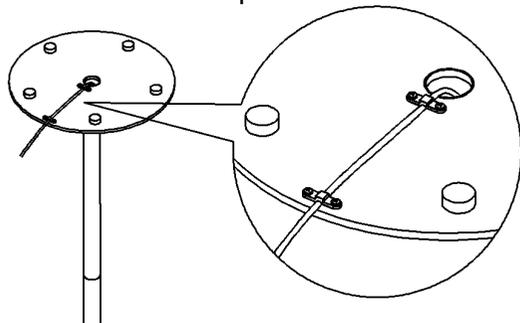
Étape 7 : Pour fixer l'appareil au sol, faire 3 trous dans le sol. À l'aide des 3 cales visser et serrer fermement.
