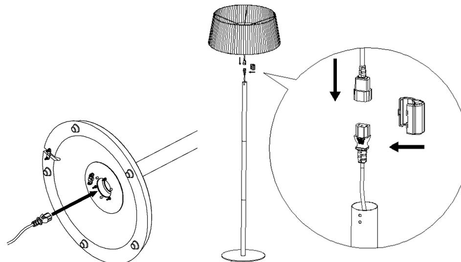
Étape 5 : Fixer la tête de l'appareil au tube supérieur à l'aide des 2 vis 4\*8mm.
