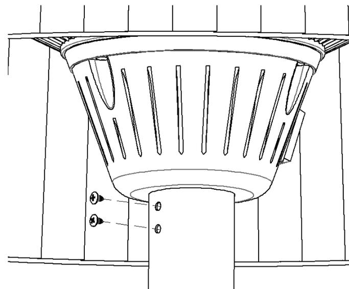
Étape 6 : (2 personnes minimum) : Fixer le cordon d'alimentation sous le socle à l'aide des quatre vis et des serre-fils
